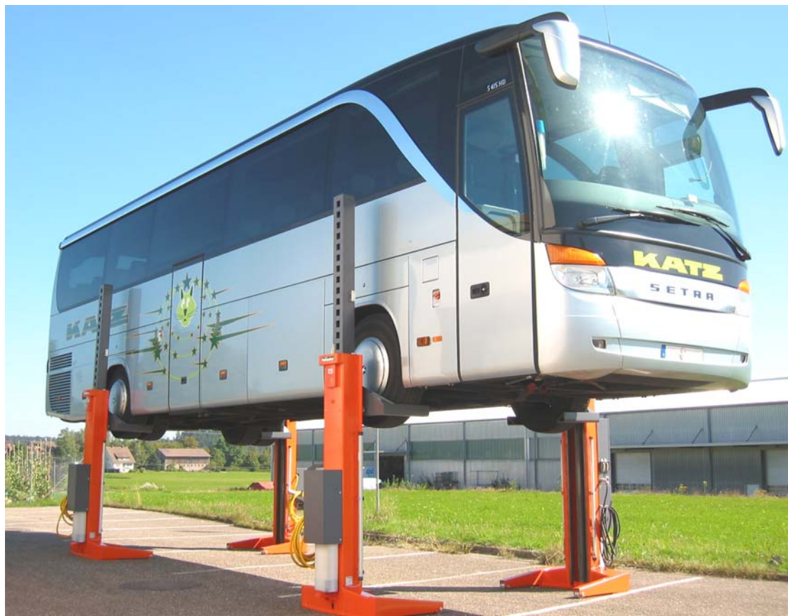
Mobil Emelő oszlop EHB806R11-4 Terhelhetőség 4 x 6 to = 24 to
